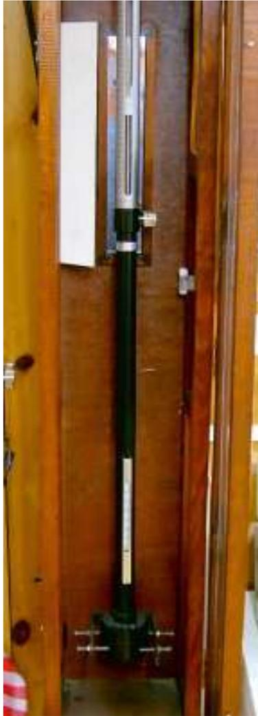
Se coloca en el interior de la estación meteorológica, ya que no puede estar expuesto al sol ni a corrientes de aire. Deben colocarse sobre paredes por las que no pasen cañerías y debe estar a una altura en la que sea fácil medir y completamente vertical.
